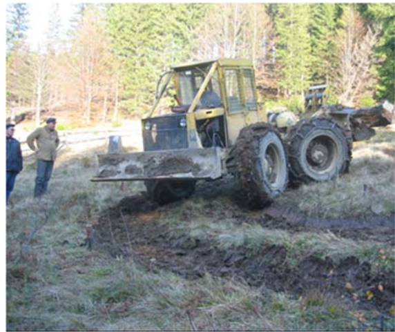
Рис. 6. Дослідження взаємодії трельовального трактора LKT-81 з опорною поверхнею. Поворот з мінімальним радіусом.
