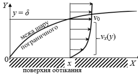
Рис.1. Розподіл швидкостей на поверхні обтікання за ламінарного пограничного шару
