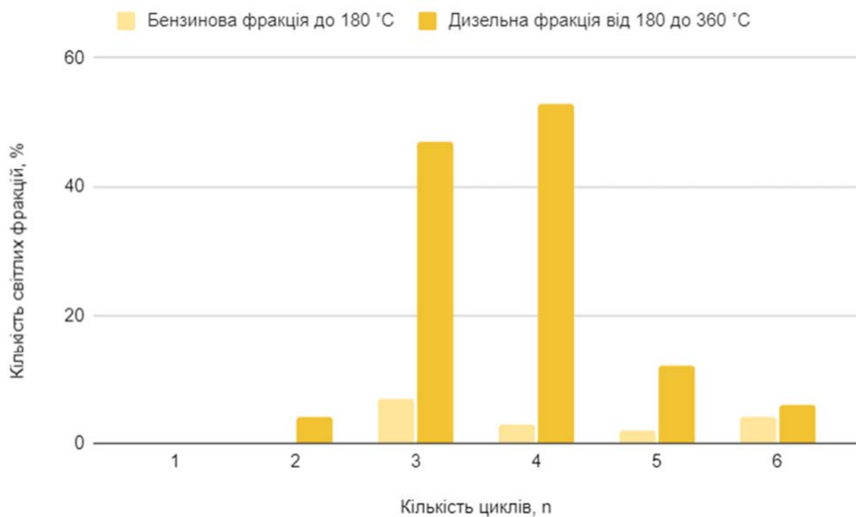
Рис.3. Стовпчаста діаграма відсотку кількості бензинових та дизельних фракцій залежно від кількості циклів
