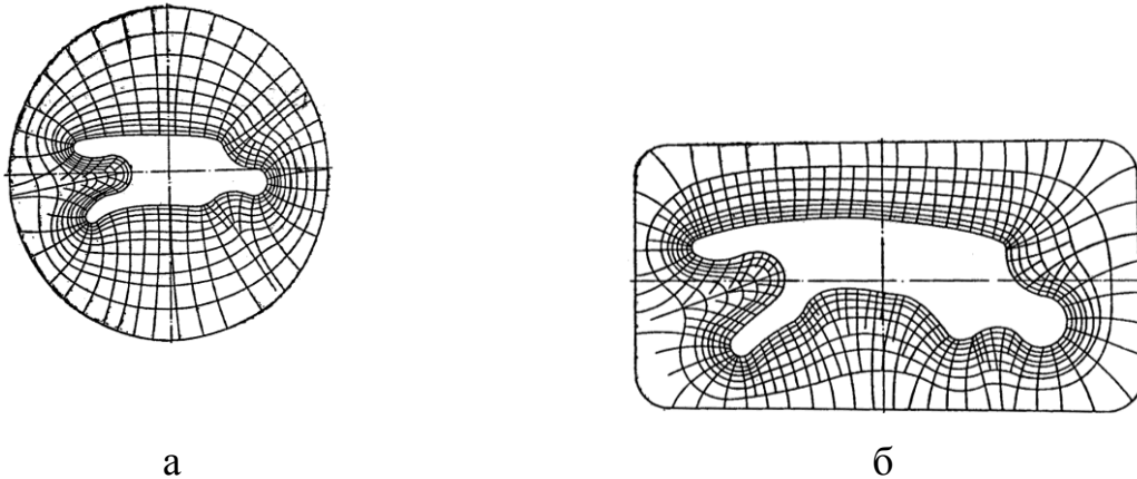
Рис. 2. Побудова переходів для філь'єр графічним методом М.І. Зверєва з експериментальним корегуванням: а – для випадку а з Рис. 1.; б – для випадку б з Рис. 1.
