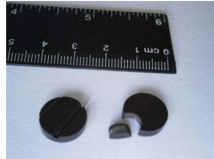
Рис. 2 - Готовий виріб, отриманий гібридним різанням
