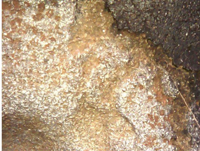
Рис. 3 – Видалення плівки окалини та поява лунок на оброблюваній поверхні
