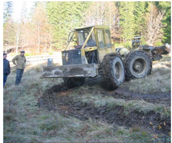
Рис. 6. Дослідження взаємодії трельовального трактора LKT-81 з опорною поверхнею. Поворот з мінімальним радіусом.
