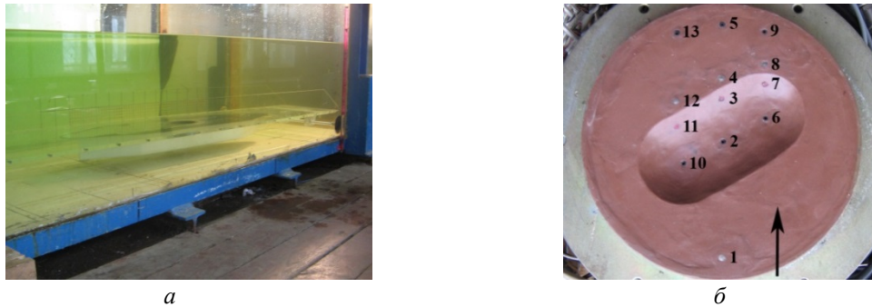
Рис. 1. Розташування виміральної пластини з овальною лункою в гідродинамічному каналі (а) та датчиків пульсацій пристінного тиску на обтічній поверхні лунки та пластини (б)
