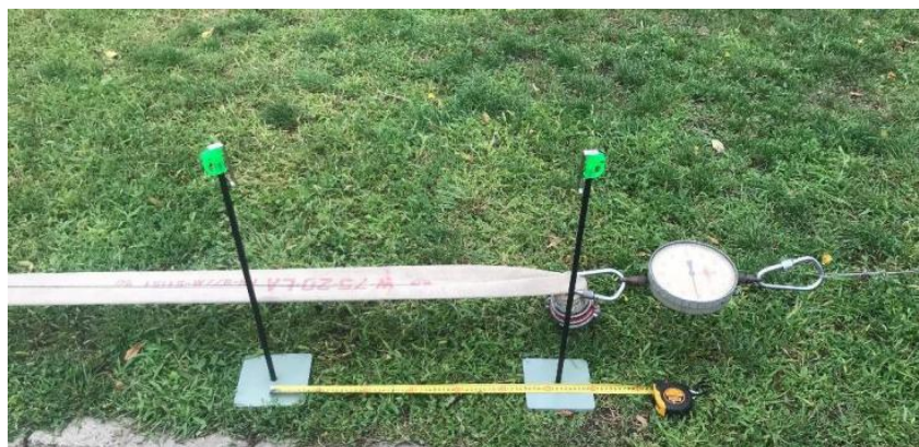
Рис. 2. Фрагмент вимірювання сили подовження латексованих пожежних рукавів довжиною 1960 см й діаметром 77 мм
