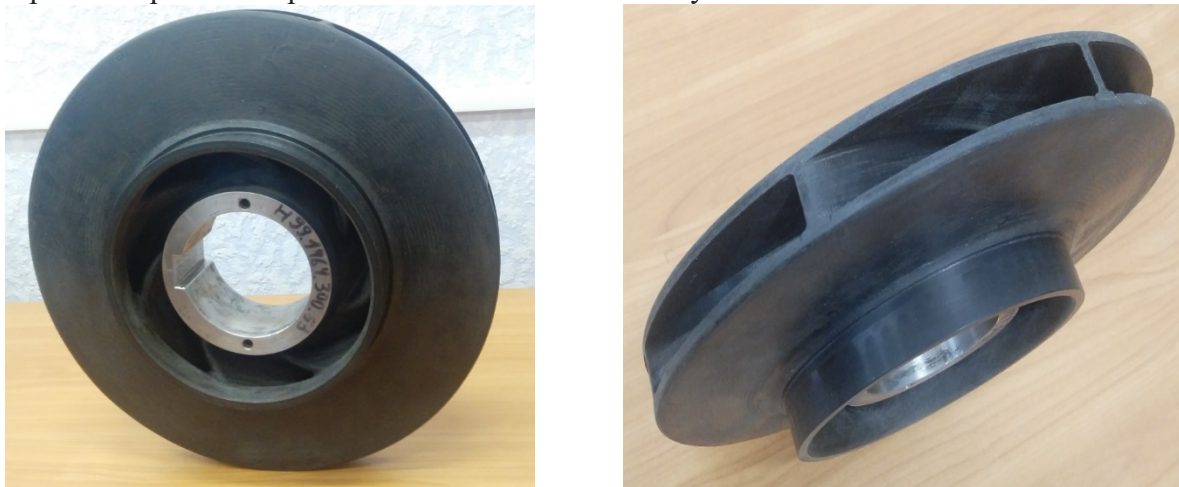
Рис. 3 — Приклад робочого колеса, виготовленого способом 3D прототипування з встановленою металеві втулкою
