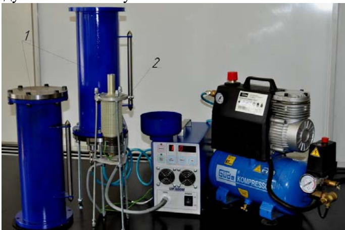
Рис. 1 – Експериментальний стенд для дослідження розміру аерозолію в камері з надлишковим тиском
