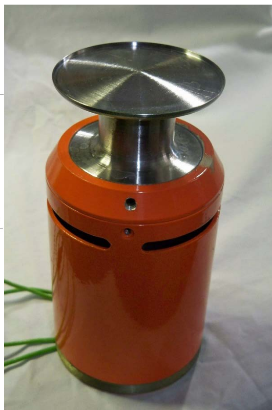
Рис. 3. Ультразвуковий диспергатор підвищеної продуктивності з прикладанням осьових коливань збудження в вузловій зоні згинальних коливань поверхні розпилення
