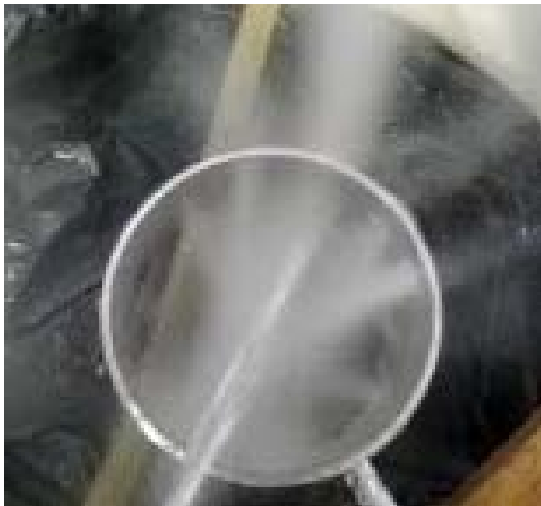
Рис.2. Ультразвуковий диспергатор з трубчастою поверхнею розпилення, що збуджується на радіально-згинальній моді коливань
