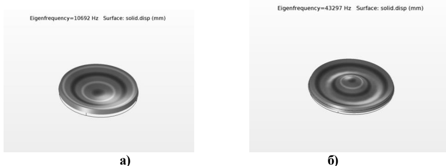
Рис. 2 – Форма собственных колебаний диска из Д16Т для первой (а) и второй (б) мод колебаний (частота 12,1 кГц, толщина диска 3мм, диаметр диска 50мм)
