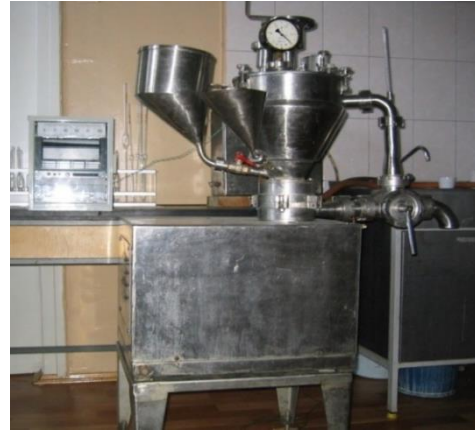
Рис.1.б - Дослідний емульсор. 1 – робоча місткість; 2 – ротор; 3 – статор; 4 – сорочка; 5 – скребкова мішалка; 6 – циркуляційний трубопровід; 7 – триходовий кран; 8 – кришка, 9а, 9б, 9в – терморпари, 10 – вимірювальний пристрій.
