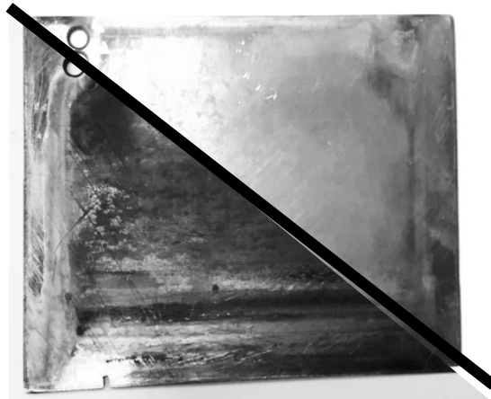
Рис. 3 - Вплив ультразвукової кавітації на пластини електролізера (ліворуч – забруднена пластина без впливу ультразвукової кавітації, праворуч – очищена пластина під впливом ультразвукової кавітації)
