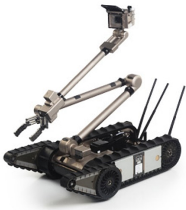
Рис. 1 - Загальний вигляд наземного роботизованого комплексу з маніпулятором важільного типу
