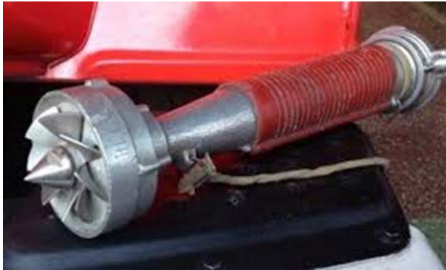
Рис 1 – Вигляд насадки НРТ-5 на пожежному стволі РС-70 (основні характеристики насадки: робочий тиск – 0,4–0, МПа, витрата води – 5 л/с, дальність подачі водяного струменя – 20 м, діаметр вихідного отвору насадки 7,5 мм)
