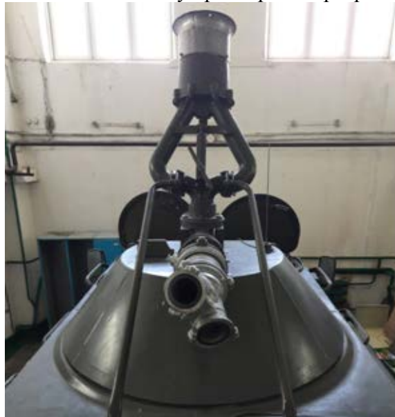
Рис 3 – Вигляд розробленого пожежного ствола, встановленого на бронетранспортер БТР–60 ПБ (Державна служба з надзвичайних ситуацій України у Миколаївській області, охорона Южно-Української атомної електростанції)
