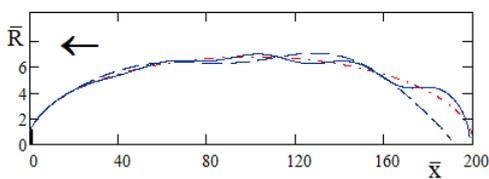
**Рис.3** Форма каверны за диском при воздействии синусо-идальных пульсаций давления,  $\sigma = 0.02$ ,  $\kappa_p = 0.5$
