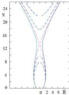
Рис. 5. Расчет нестационарной каверны за диском при вертикальном погружении с постоянной скоростью [2]
