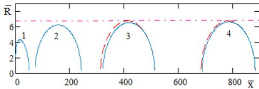
**Рис. 9** Нестационарная каверна при ускорении под воздействием компенсирующего давления в каверне
