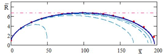
**Рис. 10** Форма каверны при ускорении под воздействием компенсации давления в подвижной системе координат
