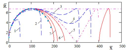
**Фиг 12** Сравнение формы нестационарной и стационарной при  $\sigma_{g\theta} = 0.02$  каверны в подвижной системе координат
