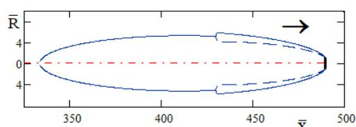
**Рис. 4** Форма каверны при скачкообразном изменении величины  $c_d$  кавитатора,  $\sigma = 0.02$ ,  $c_{di} = 0.5$ ,  $\kappa_{cd} = 0.4$
