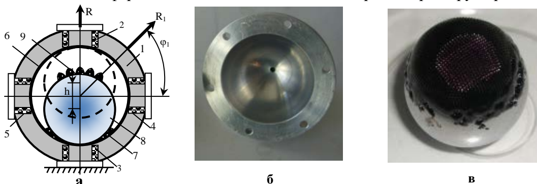
Рис. 2. Схема демпферного пристрою та його компоненти: а – конструктивна схема; б – сферична порожнина кожуха; в – магнітна сфера, що покрита феромагнітною рідиною
