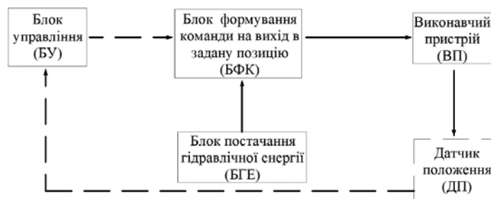
Рис. 1. Узагальнена схема електрогідравлічних позиційних приводів
