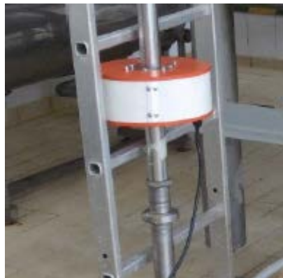
Рис. 1. Мобільний пристрій для холодної пастеризації та гомогенізації молока
