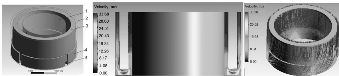
Рис.2. Поле швидкостей навколо бурової коронки
